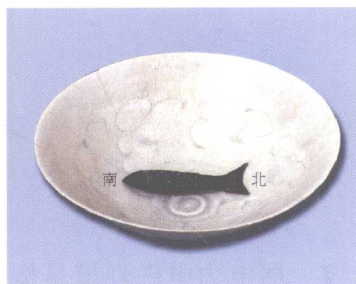
图 1-3 指南鱼——古代民间用薄铁叶剪裁成鱼形，鱼腹略下凹，磁化后浮在水面可指南北
