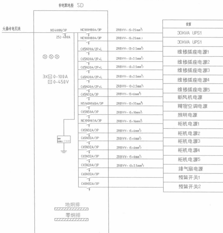
图 1-3 某中心机房市电系统图
