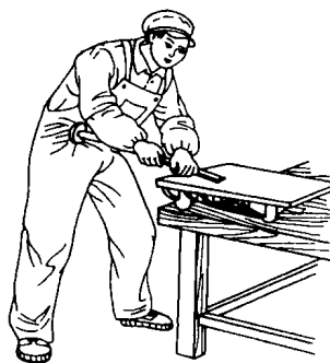
图 1.16 平面刮刀的挺刮法
