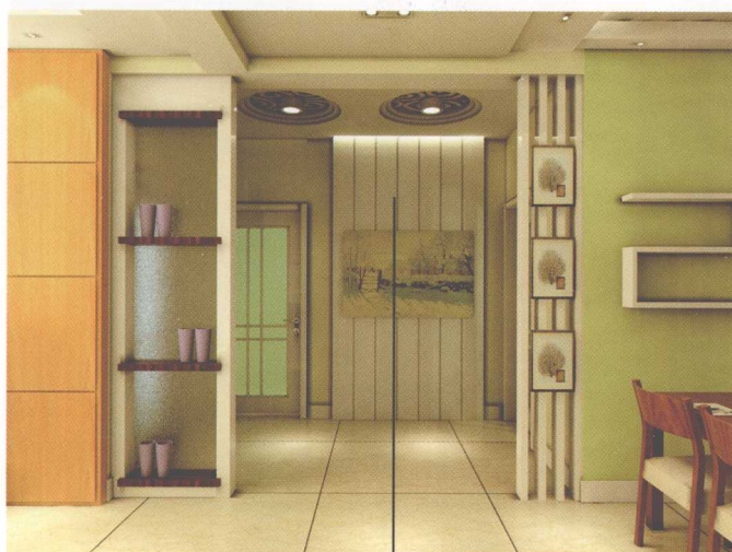
石膏板造型，乳胶漆饰面
