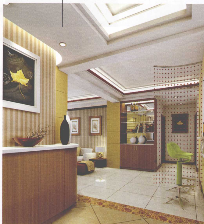
石膏板吊顶, 乳胶漆饰面
