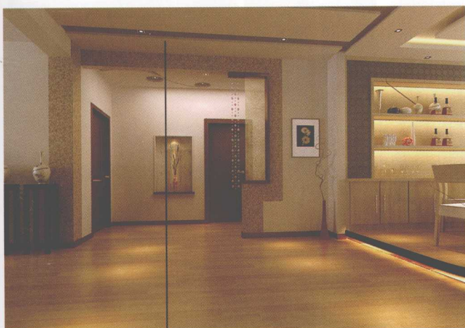
石膏板吊顶，乳胶漆饰面
