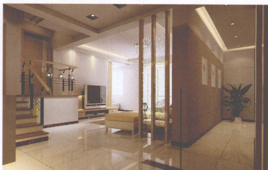
石膏板吊顶， 乳胶漆饰面
