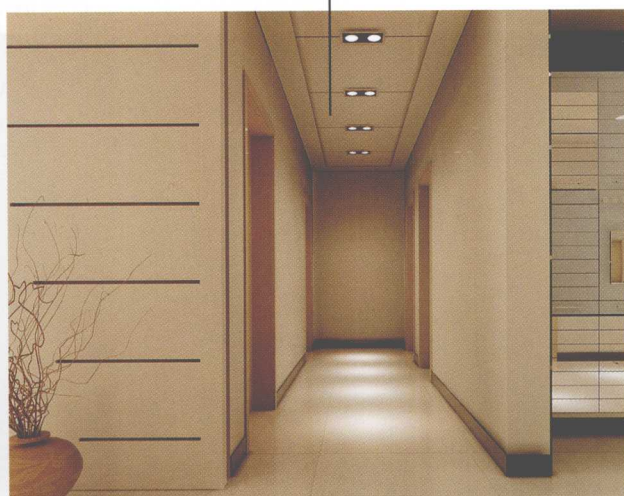
石膏板吊顶，乳胶漆饰面
