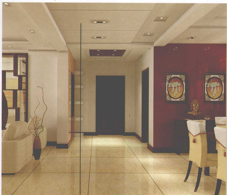
— 石膏板吊顶，乳胶漆饰面
