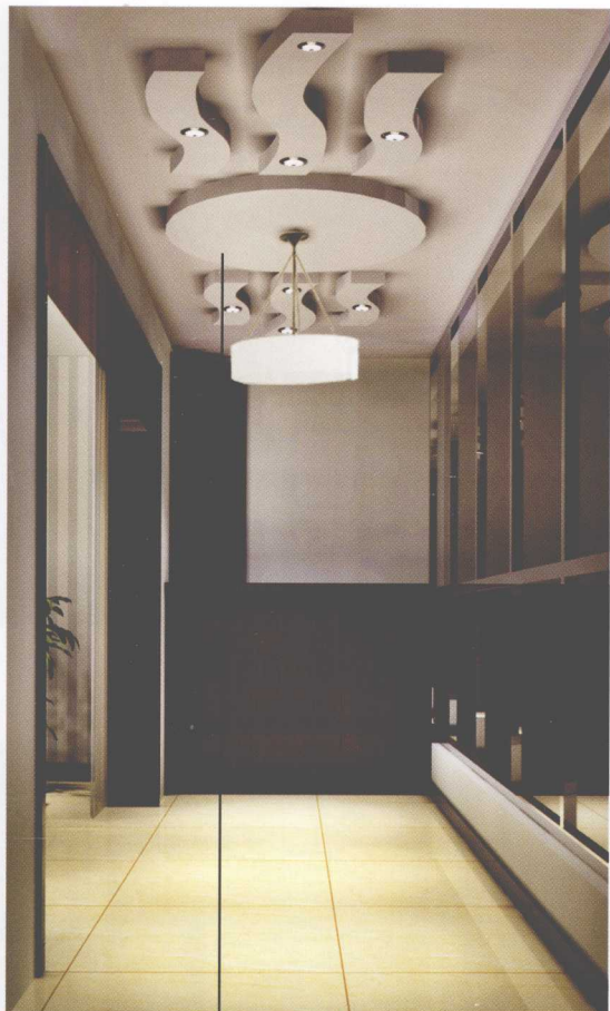
石膏板吊顶，乳胶漆饰面
