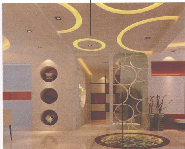
石膏板吊顶，乳胶漆饰面
