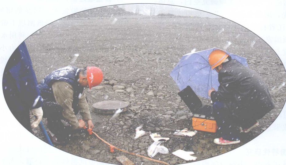
■ 四川田湾河堆石坝密度检测现场作业图（圆盘）
