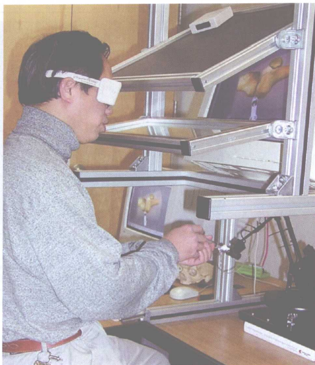
图 1-5 这个“外科”模拟器是用来为一些学生第一次进行膝关节的注射和抽吸提供体验式教学。学生手拿注射器(没有针头),注射器与触觉界面相连。这样在刺入关节腔的过程中,学生就可以感受到针尖刺破每层组织的阻力。学生可以看到膝关节的三维立体图,同时在图像中显示了其触觉位置。美国加洛拉多大学人体模拟中心
