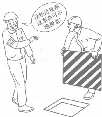
图 1-1 不得随意拆改安全防护设施
