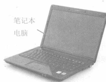
笔记本电脑的键盘下方有一个触摸板，由一个感压板和两个按钮组成。感压板可以感应手指的运行轨迹，同时屏幕中的鼠标指针随着用户手指的移动而移动，从而控制鼠标的走向。两个按钮相当于鼠标的左右键，可以帮助用户有效地操作鼠标。
