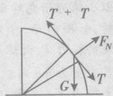
如图所示,一均匀梯子,一端放在水平地面上,另一端靠在竖直墙上,梯子与地面和墙间的摩擦因数分别为 $\mu_1$ 和 $\mu_2$ ,求梯子平衡时与地面所能成的最小夹角.
