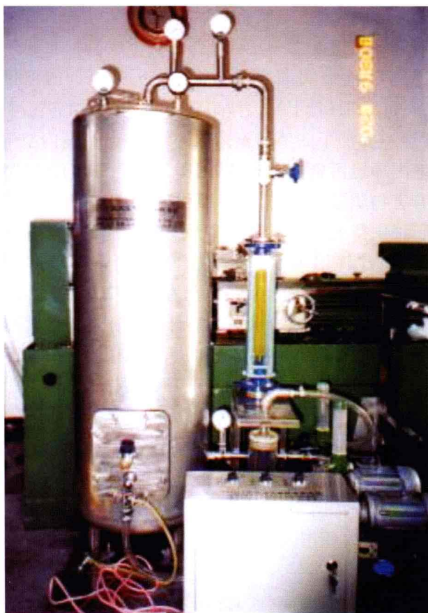
图1 研发的YSYQ-1型烟道气湍流混合稀释采样系统实物照片,正在申报专利
