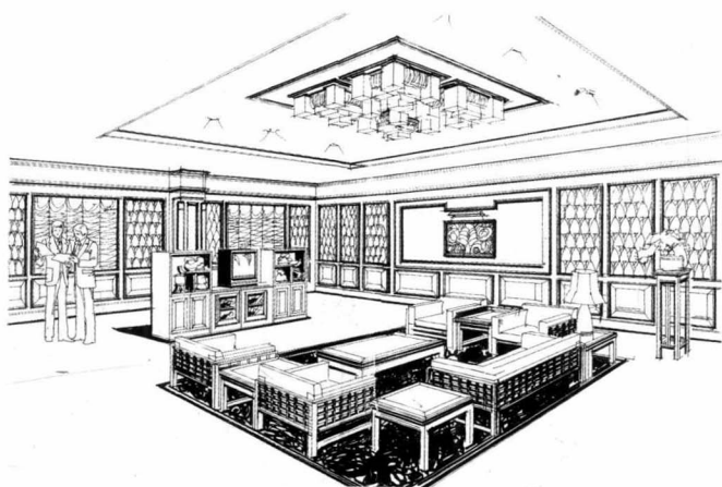
图2-7 在这个画面中，位于视平面上的两个消失点距离越近，画面透视感越强，空间感就越弱；反之，两个消失点之间的距离越远，画面的透视感就越弱，空间感也就越强。
