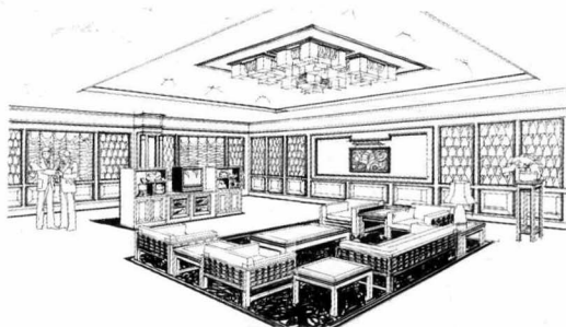
图2-7 在这个画面中，位于视平面上的两个消失点距离越近，画面透视感越强，空间感就越弱；反之，两个消失点之间的距离越远，画面的透视感就越弱，空间感也就越强。
