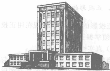
图 1-3 用中心投影法绘制的建筑物图形
