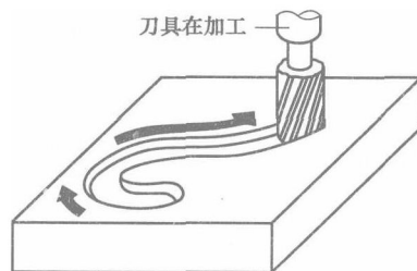
图 1-3 轮廓控制系统加工示意图
