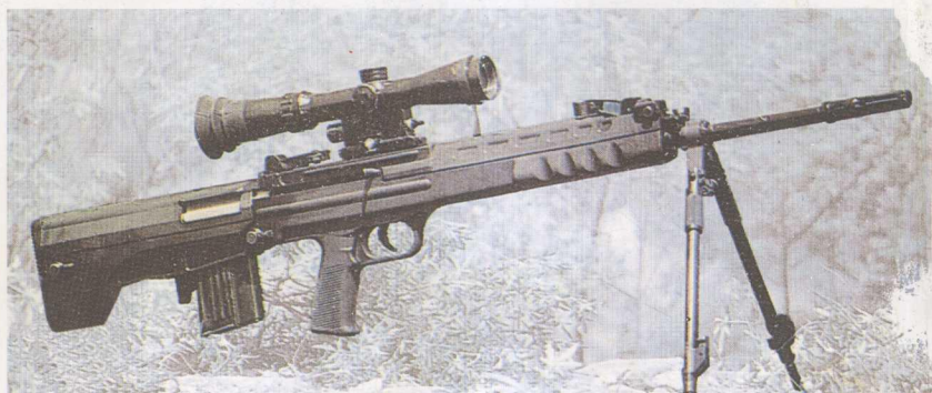
中国驻港部队装备的 5.8 毫米狙击步枪
