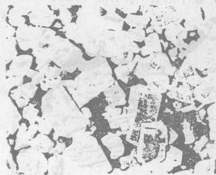
图2 热溶液 APT 试样 \times 320
