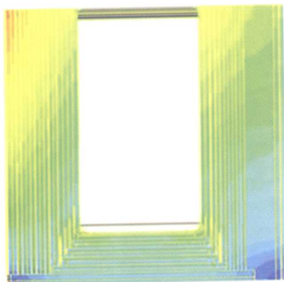
图9 1195kV DIL 电压作用下的电场分布
