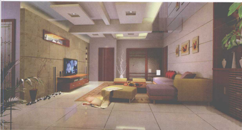
↑ 造型丰富的吊顶是该设计的一大特色，巧妙地利用了原有的横梁。玻璃镜片在吊顶的运用，增加了上下的空间感，扩展了视线。
