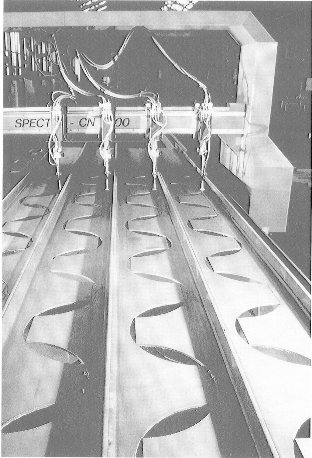
1.12 CNC(电脑数值控制)切割机上生产碟形梁
