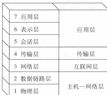
图1-13 OSI模型与因特网模型的对比
