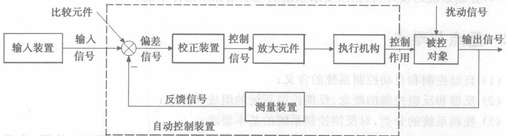
图 1-1 反馈控制系统方块图
