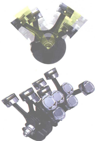
W型发动机气缸排列示意图
