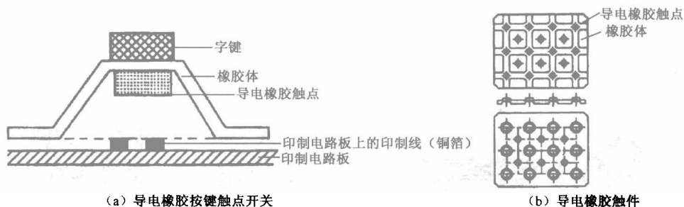
图 1-1-11 导电橡胶触点结构示意图
