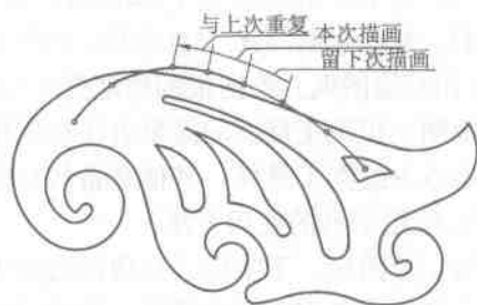
图 1—14 曲线板的用法
