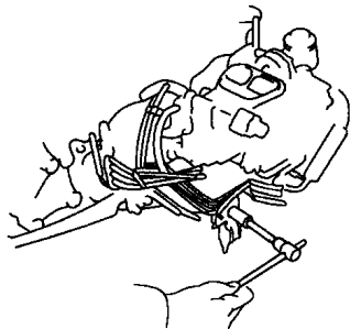
图 1-17 拆下 1 号空气管
