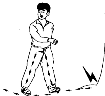
图 1-6 跨步电压触电
