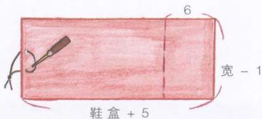
3 瓦楞板尾端钻2个洞，穿上绳子当拉手。
