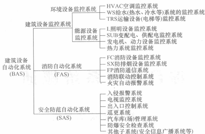
图 1-2 建筑设备自动化系统
