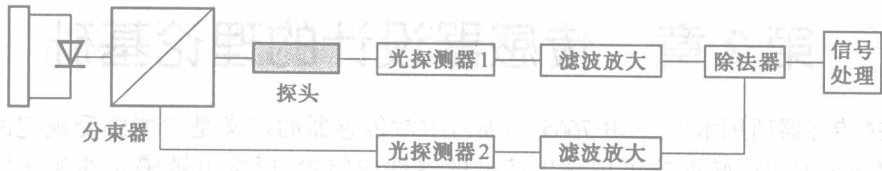
图 2.2 半导体吸收式光纤温度传感器的结构框图
