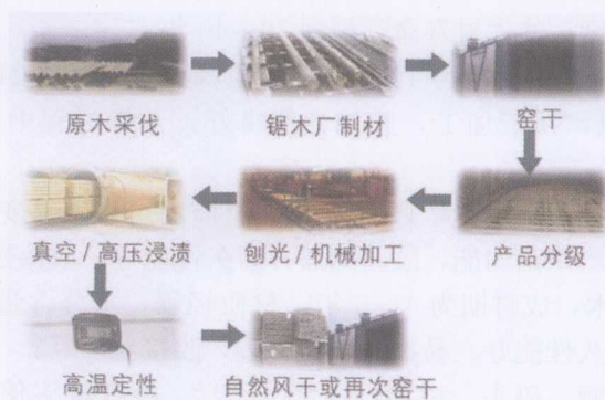
图 2-5 防腐木生产流程图
