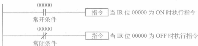
图 1-3 梯形图的常开和常闭条件
