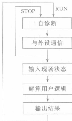
图 1-1 PLC 的扫描工作过程
