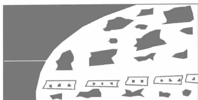
图 1-2 上方煤层及夹石层落入 开采煤层中示意图
