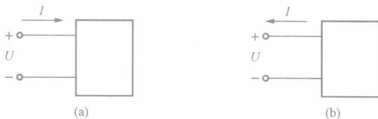
图 1-7 二端网络图形符号及电压、电流参考方向
