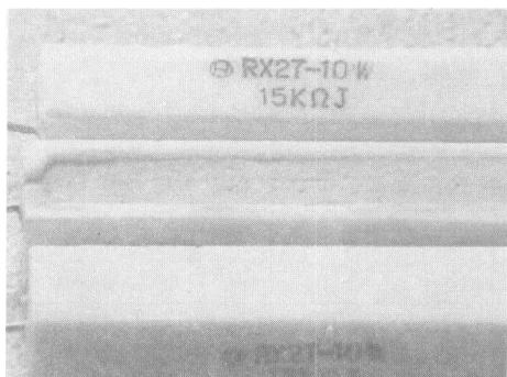
图 1-8 电阻器的额定功率
