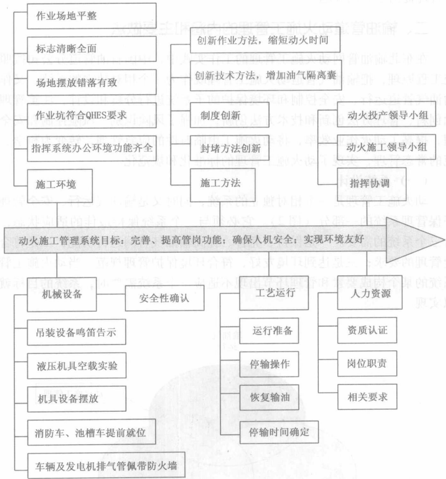
图3 动火施工管理系统构成图
