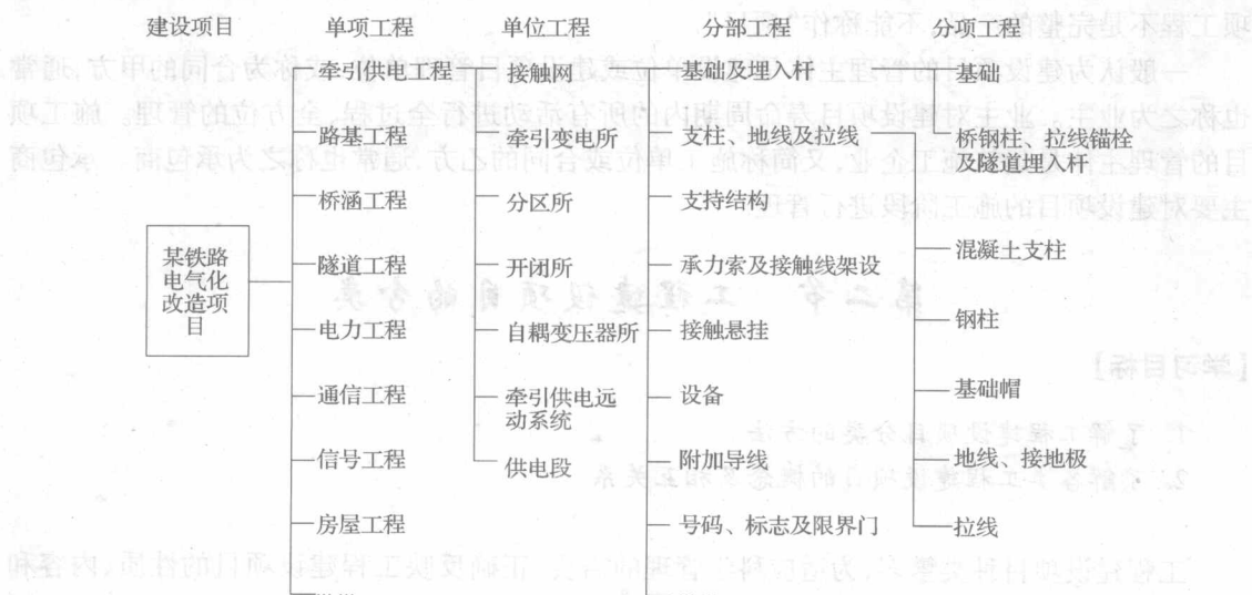
图 1-1 某铁路电气化改造项目分解图
