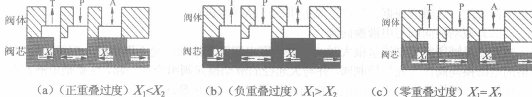
图1-1 滑阀重叠示意图
