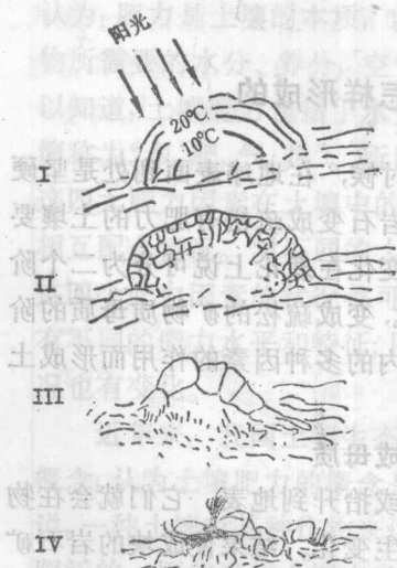
图 1-2 温度变化引起岩石胀缩不均而崩解过程示意图
