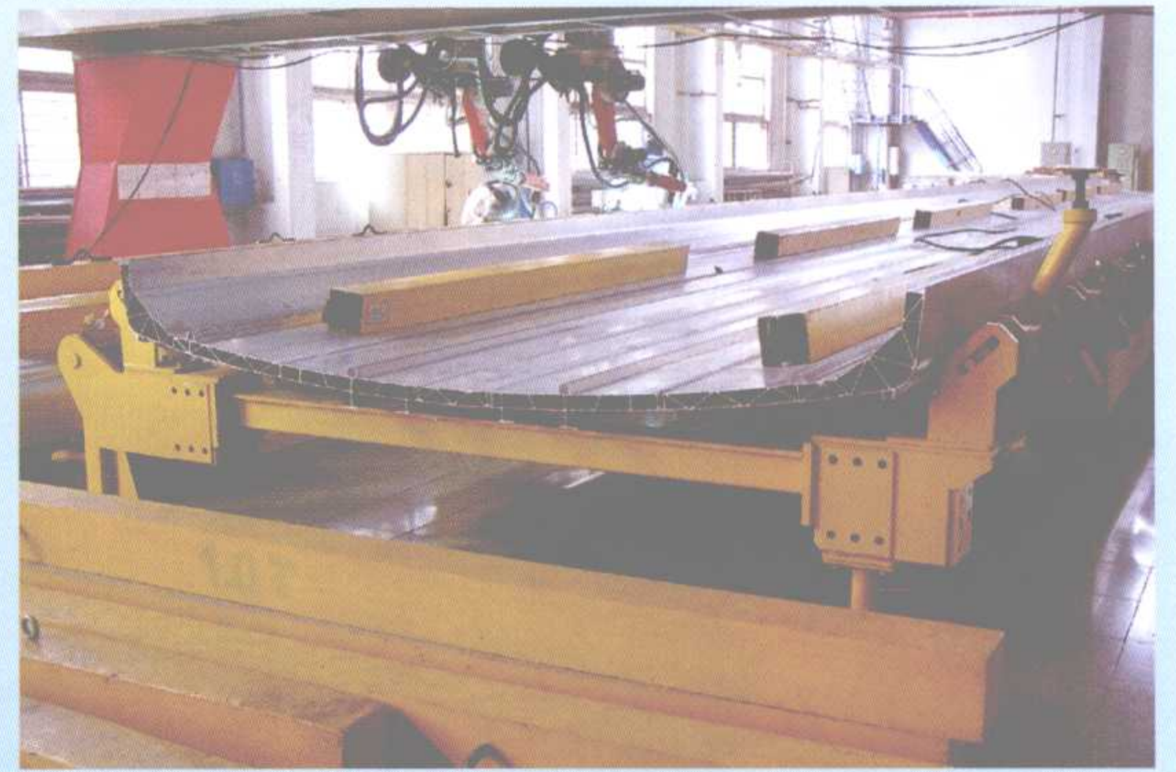
90米双机器人焊接生产线
