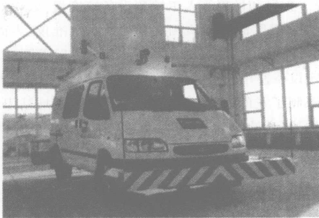
图 1-2 车辙检测装置(13 测头,CiCS)
