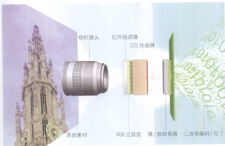
数码相机将光线转换成二进制编码。
