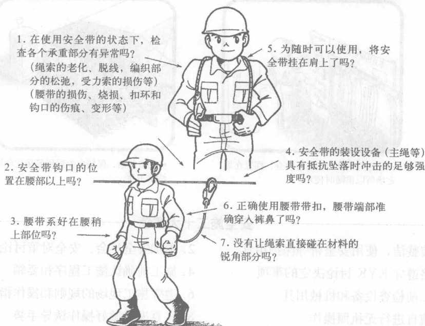
图12 安全带使用上的检查要点
