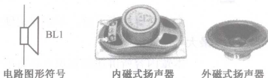
图 1-3 扬声器电路图形符号和实物图
