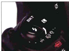
▲ D3一样支持Live View实时拍摄功能，而上面的“L”按钮则用来锁定快门或光圈值 (视拍摄模式而定)。
