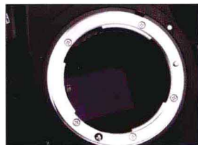
▲ D3的FX格式全片幅CMOS感光元件，有效像素为1210万。
