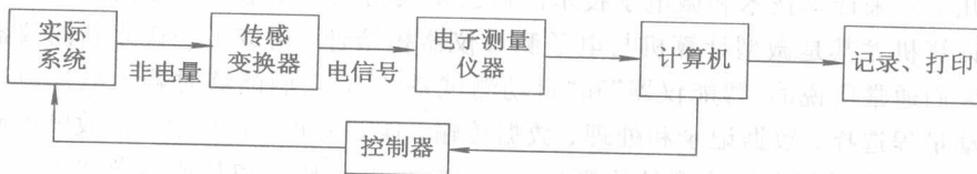
图 1.1-1 自动过程控制系统中非电量的测量
