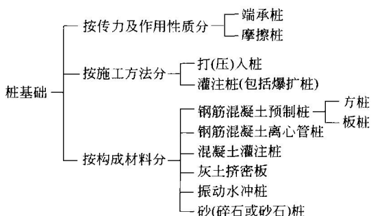
图 1-6 桩基础分类框图
