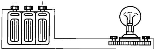
图 1.1 蓄电池对白炽灯供电电路
