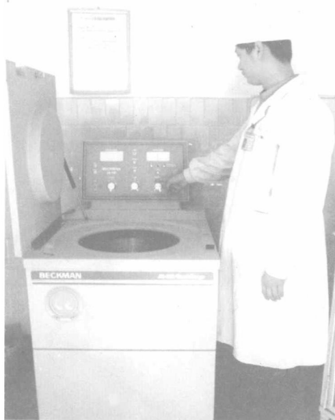
图1-12 贝克曼大容量高速低温离心机
