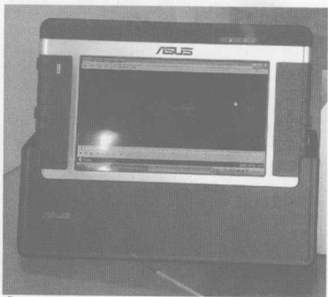
▲ 华硕的Hermes UMPC，采用了7寸的LCD屏幕，前面板采用橡胶保护设计，让设备的抗摔性大大提高，而且防水防尘。
