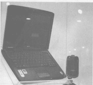
▲ 在本次Computex大会上，ACER推出了新外观设计的Aspire家用笔记本电脑与TravelMate商用笔记本电脑，不过最吸引人的还是那台法拉利。旁边哪个东西是什么？仔细瞧瞧，原来是同样采用法拉利外观的C500 GPS。C500采用2.8英寸QVGA屏幕，拥有蓝牙和802.11 b/g无线网络，SD存储卡插槽以及ALK CoPilot v6.0导航软件。
