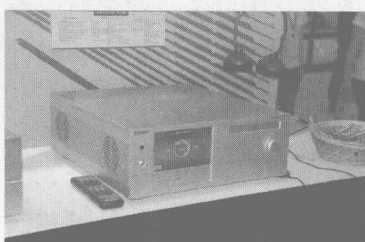
▲ T1展出的手工打造的铝质机箱“剑侠”，顶端和侧面板利用气压棒来开启，可增加机箱与外界空气的对流。另外可以再加上最多12个12cm的系统风扇加强散热。这款机箱还拥有T1首创的7英寸扩展槽，可以安装折叠式的7英寸LCD屏幕，达到双螢幕的效果。该机箱内还搭配了T1新推出的Toughpoer 1200W高性能电源和V1散热器。
