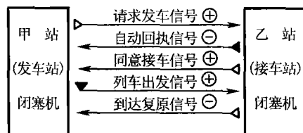
图 1-2 64D 型继电半自动闭塞 两站间传送的闭塞信号
