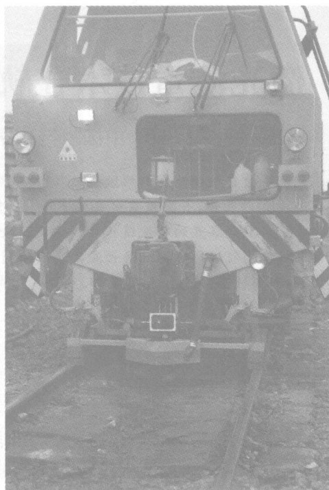
图4 安装的两维激光接收器
